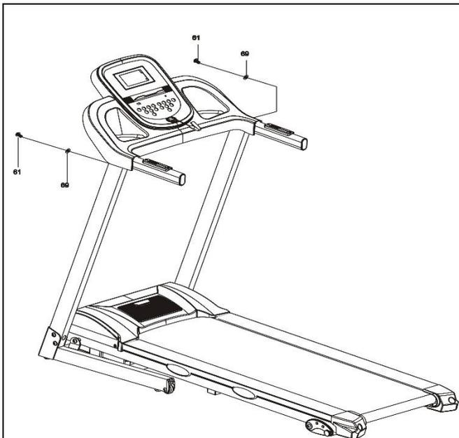
1. Используйте ключ на 5 мм(12) для установки консоли, левой и правой направляющих с помощью 2 болтов М8\*15(61) и 2 шайб М8(69). Обратите внимание на подключение кабеля, неверное подключение может привести к повреждению соединительного разъема.
