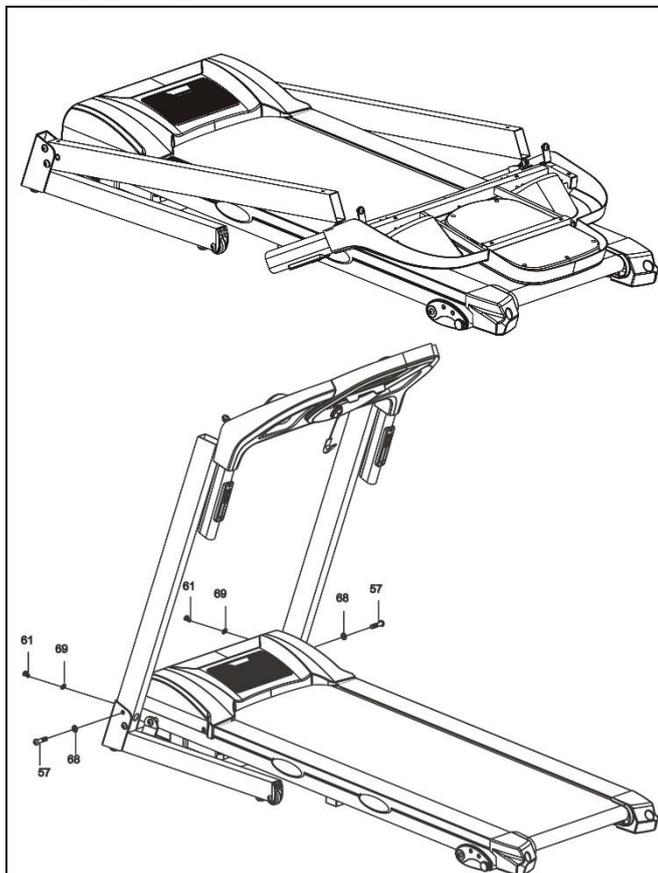
1. Поднимите направляющие и консоль. Установите направляющие с помощью 2 винтов M10\*40(57), 2 шайб M10(68), 2 винтов M8\*15(61) и 2 шайб M8(69), а также ключа (13). Обратите внимание на подключение кабеля, неверное подключение может привести к повреждению соединительного разъема.
