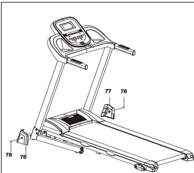
1, Используйте отвертку (11), чтобы установить левый кожух платформы (76) на платформу с помощью одного М4х10 (78), как показано на рисунке. Повторите процедуру для правого кожуха платформы (77).
